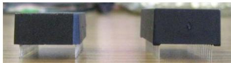
M48T08 Original (左) と詐欺製品 (右) で、高さ、横幅共に Original より大きめ
